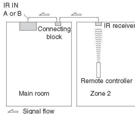
連結塊的 miniplug 繼線應該被連接到AV接收機的IR IN A或B插孔。如下圖, IR IN A和B插孔相同, 上方兩個IR接收器應該被連接。
