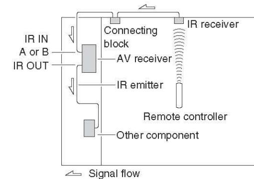
IR發射器應該被連接至AV接收機的IR輸出端，如下圖。
