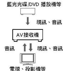
視訊設備可以利用下列任何一種視訊連接格式連接到：複合視訊、色差視訊或 HDMI，最後一種格式可以提供最佳圖像品質。
