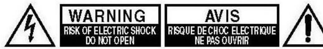
等邊三角形內帶箭頭的閃電指示標識，用於警告用戶在產品內部有非絕緣的危險電壓存在，可能造成電擊的危險。
